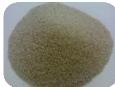
Cát lọc nước
